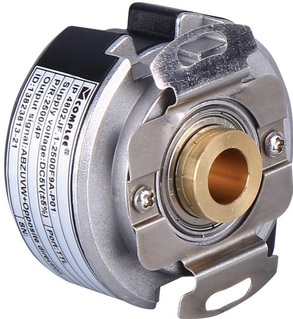
旋转编码器安装时应注意的点：安装时不要给轴施加直接的冲击。编码器轴与机器的连接，应使用柔性连接器。在轴上装连接器时，不要硬压入。即使使用连接器，因安装不良，也有可能给轴加上比允许负荷还大的负荷，或造成拨芯现象，因此，要特别注意。轴承寿命与使用条件有关，受轴承荷重的影响特别大。如轴承负荷比规定荷重小，可延长轴承寿命。不要将旋转编码器进行拆解，这样做将有损防油和防滴性能。防滴型产品不宜长期浸在水、油中，表面有水、油时应擦拭干净。
